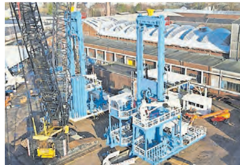
2026 lieferte HMH in Erkelenz zwei besonders komplexe Pfahlbohrmaschinen für Fundamente einer Offshore-Bohrplattform vor der Küste Australiens.
